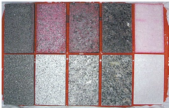
■写真3/赤インク浸漬試験(24時間経過状況)
